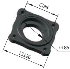
Крышка корпуса подшипника Р33.БДЛ-322 M = 1,09 кг
