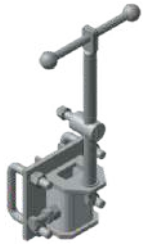
Механизм подъема в сборе РЗЗ.06.300-02 М = 13,41 кг
