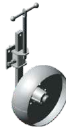
Механизм заднего колеса РЗЗ.06.000-05 М = 62,2 кг
