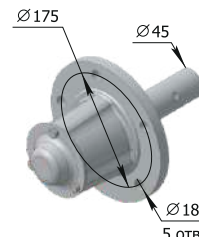
Ступица колеса ПЛЕ РЗЗ.06.200-Б М = 13,66 кг
